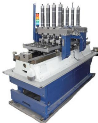
Lebensdauerprüfstand für Profilschienenführungen bewegte Schienen
