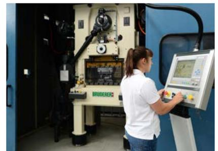
Schnellläuferpresse zur Untersuchung von Umform- und Schneidprozessen
