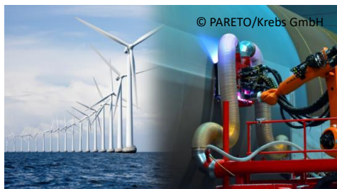
Thermische Spritzverzinkung für offshore-WEA
