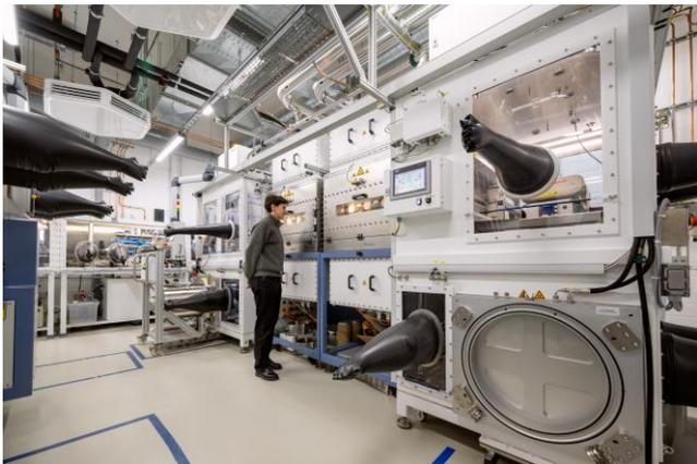
Abbildung 5: Experimentelle Beschichtungs- und Trocknungsanlage von Elektroden unter Argon-Atmosphäre (Bildquelle: TUM / Andreas Heddergott)
