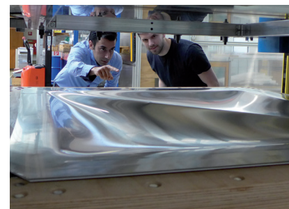
Umformwerkzeug zur Herstellung großflächiger Gebäudefassadenelemente
