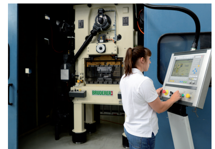
Schnellläuferpresse zur Untersuchung von Umform- und Schneidprozessen
