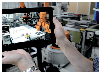
Cloudbasierte Augmented-Reality-Simulation einer Robotersteuerung
