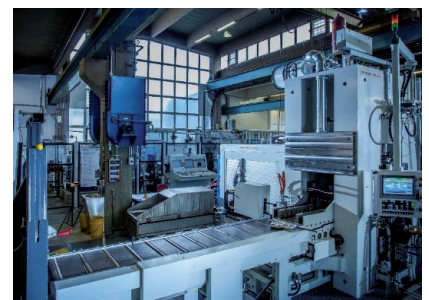
4 MN Universalwalzwerk zum Warm- und Kaltwalzen (Quelle: Ahrens+Steinbach Projekte)
