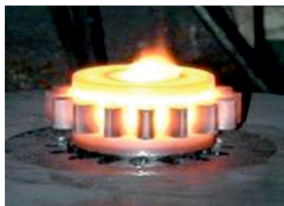
Präzisionsgeschmiedetes Zahnrad nach der Formgebung
