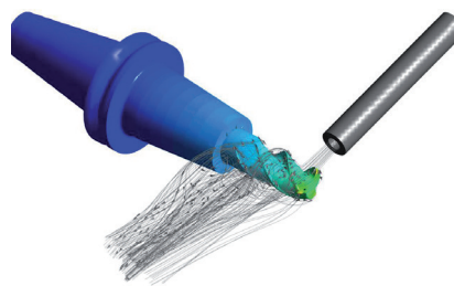
Maschinen-Prozess-Analyse zur gezielten Wärmeabführung
