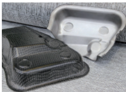
Hybridbauteil – Verbund aus Metal und faserverstärktem Kunststoff (Textil)
