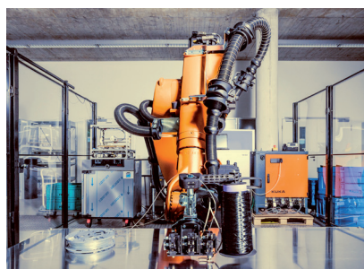
3D-Drucker „Fiber Printer“ für die additive Fertigung von funktionalen Materialien
