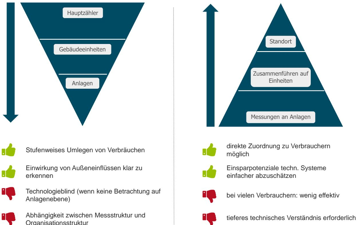
Abbildung 3-3: links: Top-down Ansatz; rechts: Bottom-Up Ansatz (Weigold 2020)
