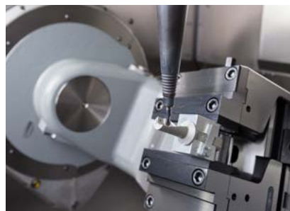
Nachbearbeitung eines additiv hergestellten Werkzeugs
