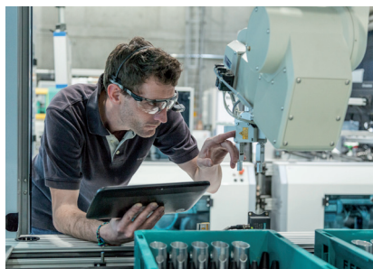
Werker und Roboter können nun auch ohne Zaun miteinander kooperieren Quelle Fraunhofer IPA/Rainer Bez
