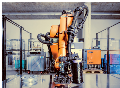
3D-Drucker „Fiber Printer“ für die additive Fertigung von funktionalen Materialien Quelle Fraunhofer IPA/Rainer Bez/Heike Quosdorf
