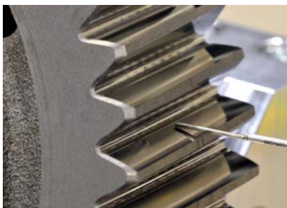
Rauheitsmessung einer feingeschliffenen Zahnflanke
