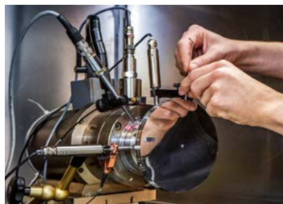
Präzisionswuchten einer luftgelagerten Spindel für die Diamantbearbeitung optischer Strukturen
