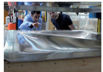
Umformwerkzeug zur Herstellung großflächiger Gebäudefassadenelemente
