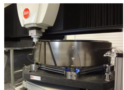
Messung eines Großverzahnungsnormals mittels Koordinatenmessgerät
