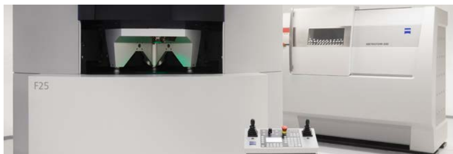
Klimatisierter Messraum mit hochgenauem Mikrokoordinatenmessgerät, CT, sowie weiteren optisch taktilen Messmitteln
