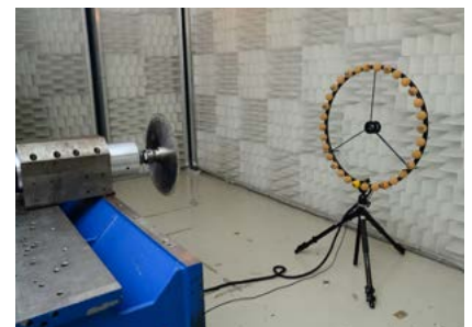
Schallemissionsmessung mit akustischer Kamera
