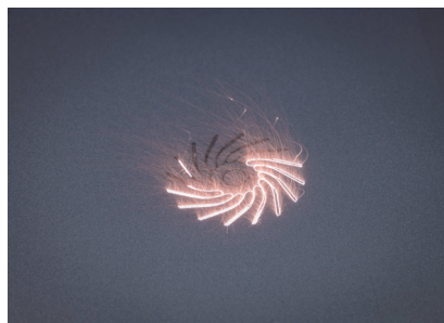
Laser-Pulverbettsschmelzen eines Impellers, Quelle: KIT/Markus Breig
