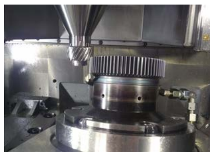
Wälzschälen mit kleinen Achskreuzwinkeln
