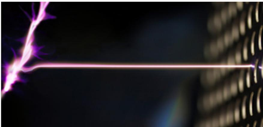
Laserstrahlgeführtes Filament (Foto: K. Cvecek, blz)
