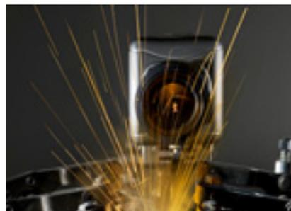
Prozessbeobachtung durch eine Hochgeschwindigkeitskamera beim Laserstrahlschweißen (Foto: Uwe Mühlhauer, [www.uwe-muehlhaeuser.de](http://www.uwe-muehlhaeuser.de))
